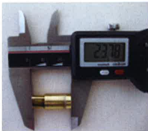
17.10.10) Atomiseur, longueur de la partie cylindrique : 15,75 +/- 0,25 mm
