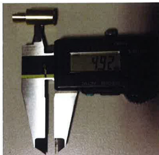
17.10.13) L'insert du carburateur doit porter l'inscription "12,5"
