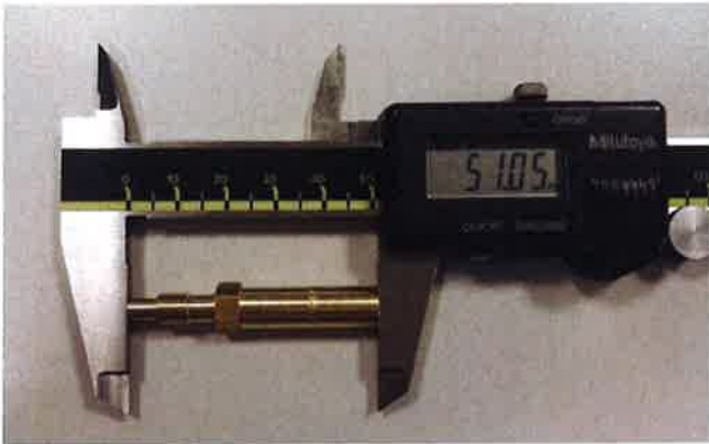
17.10.5) Longueur de la section basse : 33,0 +/- 0,45 mm.
