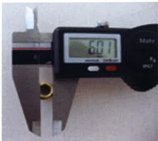
17.10.11) Atomiseur, dimension de la coupe : 5,8 +/- 0,3 mm
