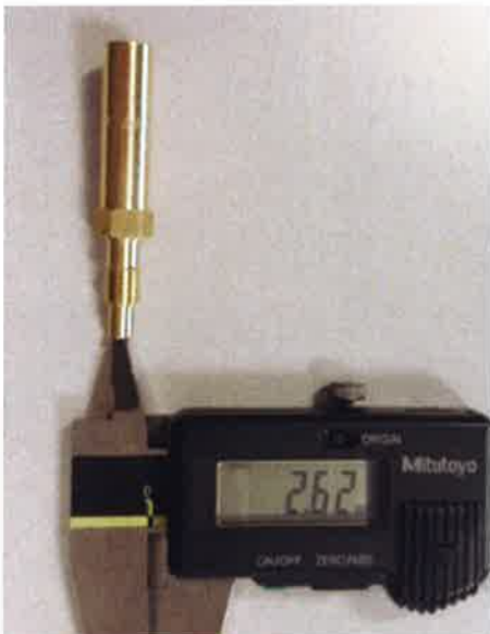
17.10.7) Le gicleur de ralenti Le gicleur de ralenti doit porter la mention "60". La pige de 0.65mm ne doit pas entrer dans le trou. (Utiliser le jeu de piges Rotax réf. : 281 920).
