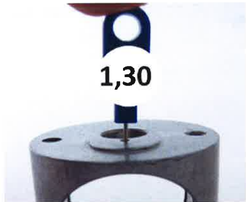
17.10.15) Une jauge de contrôle de 1,30mm ne doit pas entrer dans le trou vertical. (Utiliser le jeu de jauges de contrôle Rotax réf. : 281 920).
