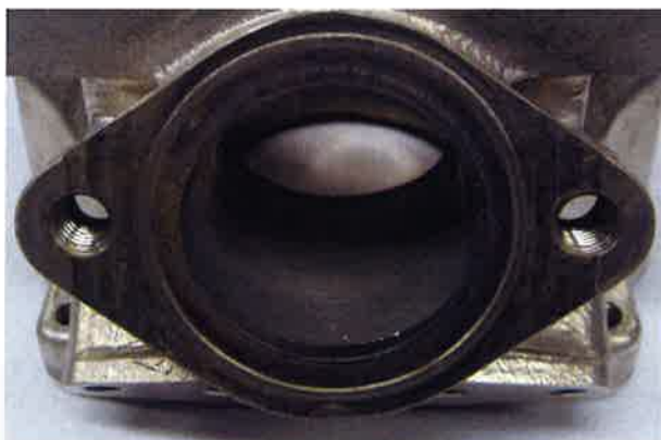
■ La partie supérieure du collet d'échappement à une finition moulée ou usinée. Dans le cas d'une finition usinée (photos ci-dessous), la surface peut être plate ou présenter un bossage.
