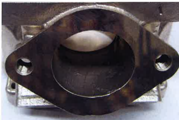
■ La partie supérieure de la lumière d'échappement peut présenter une finition moulée :
