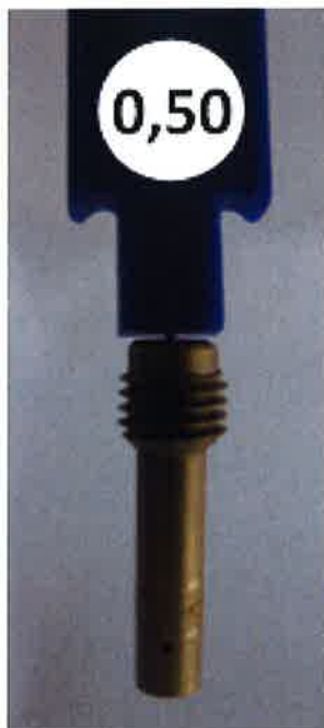
17.10.8) Le gicleur d'émulsion Le gicleur d'émulsion doit porter la mention "45". La pige de 0.50mm ne doit pas entrer dans le trou. (Utiliser le jeu de pige Rotax réf. : 281 920).
