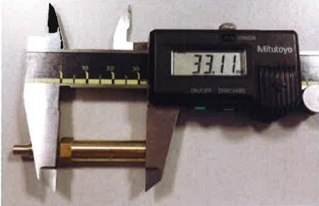
17.10.5) Longueur de la section basse : 33,0 +/- 0,45 mm.
