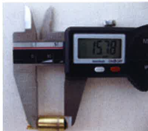
17.10.10) Atomiseur, longueur de la partie cylindrique : 15,75 +/- 0,25 mm
